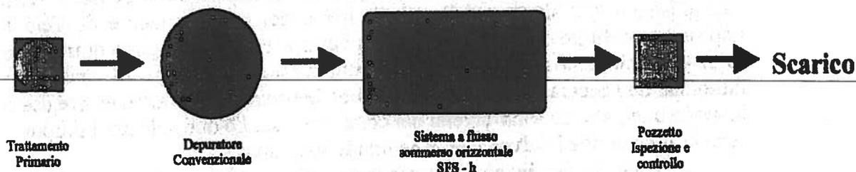
*Fig. 5 – Schema preliminare dell'impianto di postrattamento di Formello*
